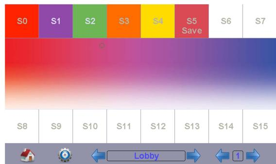
Ein weiteres Feature ist die Unterstützung von DALI DT8 RGB-Leuchten. Das Display ermöglicht das Speichern von RGB-Werten für Szenen. Um vor dem Abspeichern die Stimmung verifizieren zu können wird die ausgewählte Farbe an der aktuell ausgewählten Leuchtengruppe in Echtzeit mitverstellt. Somit lassen sich über die Szenen auch verschiedene Farbstimmungen realisieren.
